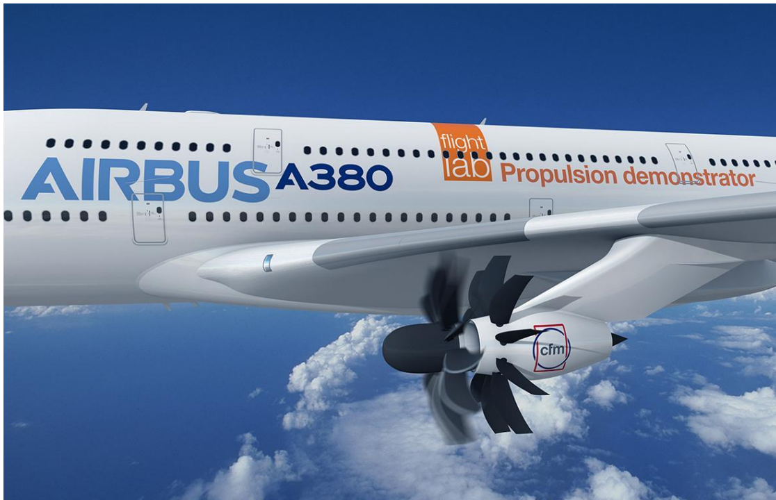
Figura 11. Motor de rotor abierto RISE de CFM [Airbus]
