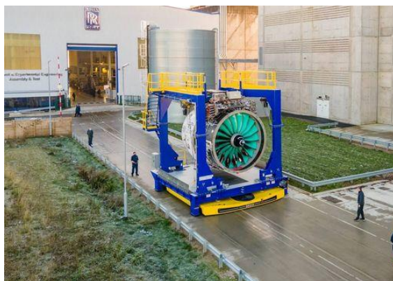
Figura 10. Motor de gran relación de derivación Ultrafan [Rolls-Royce]
