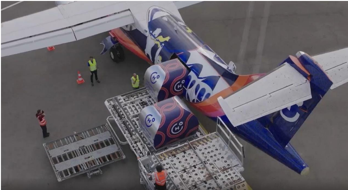
Figura 47. Prueba de repostaje mediante contenedores de hidrógeno [Universal Hydrogen]
