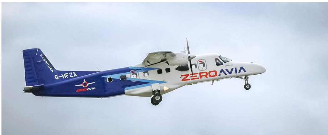
Figura 45. Primer vuelo del Dornier 228 con un motor eléctrico alimentado por pilas de H2 [ZeroAvia]
