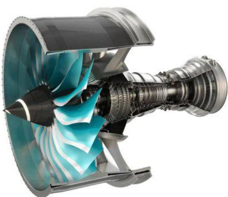
Figura 10. Motor de gran relación de derivación Ultrafan [Rolls-Royce]
