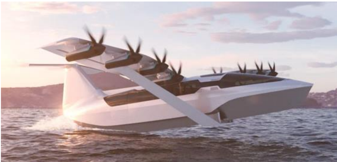
Figura 37. Ekranoplano eléctrico Viceroy para 12 pax y 300 km de alcance [Regent]
