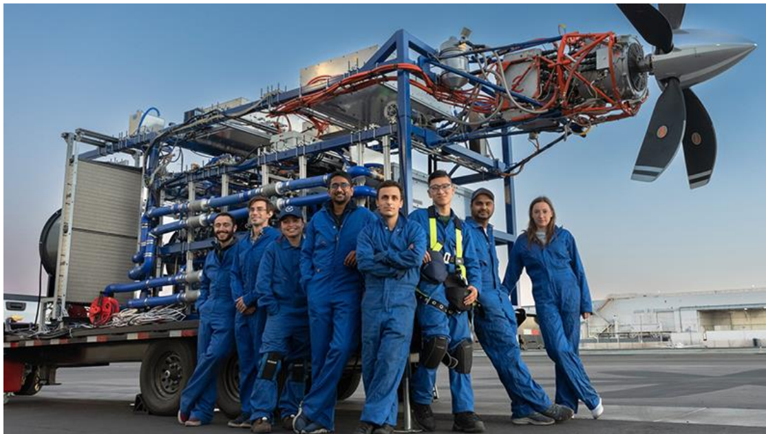
Figura 49. Pruebas en tierra de un propulsor eléctrico con pilas de H2 de 1 MW de potencia [Universal Hydrogen]
